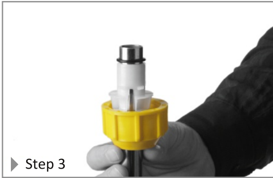
▶ Step 3 Røret med O-ring, adapter og forskruining er klar til montage på Aqua Level ventilhus / Water pipe with O-ring, adapter and branch is ready to be connected to the valve housing / Das Rohr mit Dichtungsring, Adapter und Überwurfmutter kann auf dem Kopfstück montiert werden.
