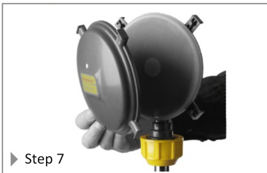
▶ Step 7 Låget sættes på over membran / Lid placed on top of membrane / Der Frontkappe auf die Membran legen.
